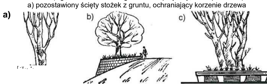
Rys. 2. Zabezpieczenie drzew przy obniżeniu terenu, po wykonaniu wykopów (wg N.P. Ornatski: Drogi i ochrona przyrody, Transport 1982)
